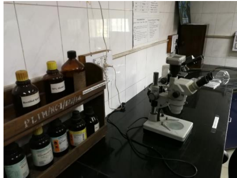
กล้อง stereo microscope ใช้สำหรับ ตรวจสอบเอกลักษณ์ของพืช
